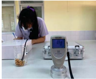
รูปที่ 12 เครื่องทดสอบวัดความชื้น โดยเครื่อง Water Activity Meter รุ่น AW-1A
