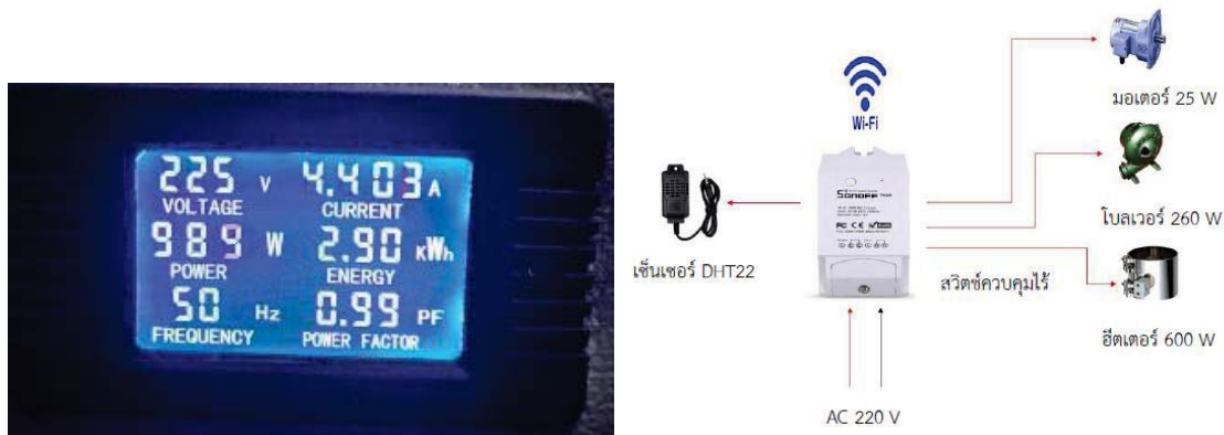
ภาพที่ 5 การทำงานของระบบควบคุมเซ็นเซอร์ lot
