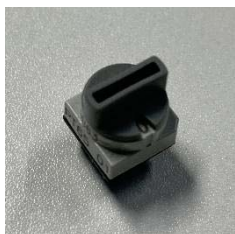
รูปที่ 7 สวิตช์บีซีดี และต้นแบบสวิตช์บีซีดีภายนอก
