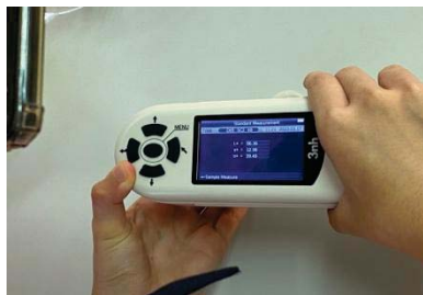
รูปที่ 13 เครื่องทดสอบหาค่าสี โดยเครื่อง Colorimeter รุ่น NR200
