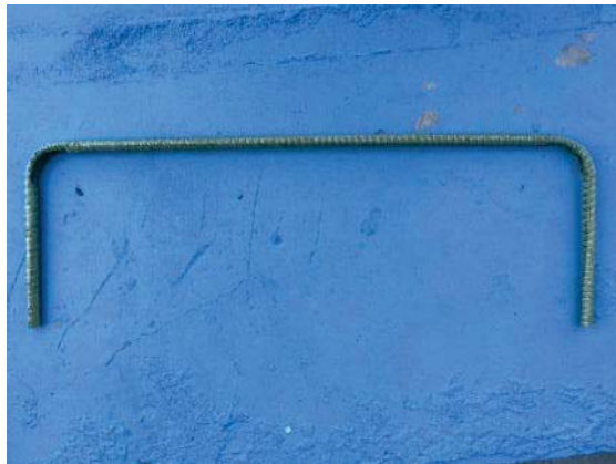
รูปที่ 2 GFRP Rebar ขนาดเส้นผ่านศูนย์กลาง 16 mm งอขอ 90°
