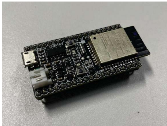
รูปที่ 2 บอร์ดอีเอสพี 32 รุ่น Ayarafun/LamLoei Node32S Plus
