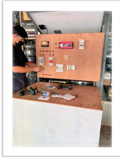
ภาพที่ 2 ชุดสาธิตระบบผลิตพลังงานแสงอาทิตย์โดยใช้ชุดเซลล์แสงอาทิตย์
