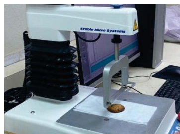
รูปที่ 11 เครื่องทดสอบเนื้อสัมผัส โดยเครื่อง Stable Micro Systems
