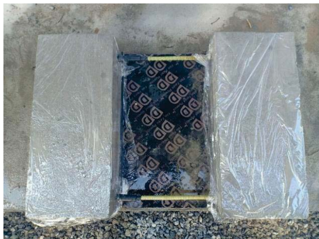
รูปที่ 9 บ่มคอนกรีตให้ครบ 28 วัน
